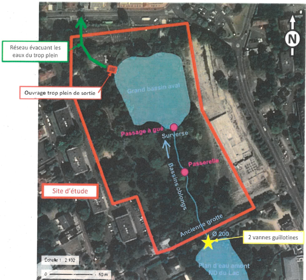
ANNEXE 1 : SCHÉMA HYDRAULIQUE DU SITE (SOURCE DOSSIER LOI SUR L'EAU 27/10/2020)
